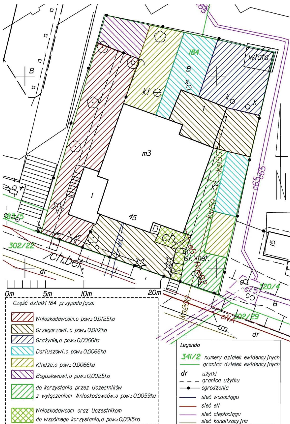
Ryc. 1. Fragment mapy do celów prawnych sporządzonej na podkładzie mapy zasadniczej z projektem podziału „do korzystania”
